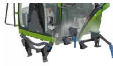
Механическая система амортизации кабины спереди опирается на два подшипника с коническими роликами, а сзади на два механических упругих элемента.
