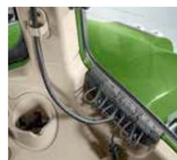
Специальный проем позволяет аккуратно проложить кабель в кабину, при закрытом заднем стекле, при этом сохраняя прежний уровень защиты от загрязнений, воды и шума.
