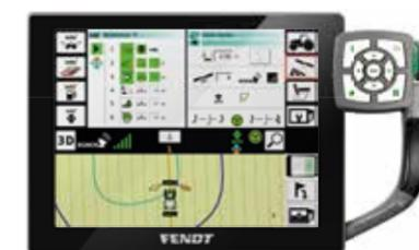
Автоматизация разворотной полосы VarioTronic<sup>1</sup> позволяет снизить нагрузку на оператора при выполнении разворотов. VarioTronic<sup>1</sup> автоматически выполняет точную последовательность в нужном месте.
