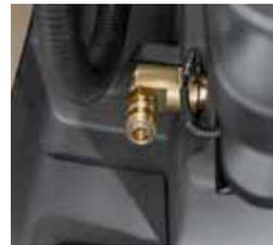
Кабину также можно быстро очистить: Сиденья водителя (комфортное сиденье класса люкс Evolution) оснащены удобным подключением для пневмошланга, с помощью которого можно очистить кабину.
