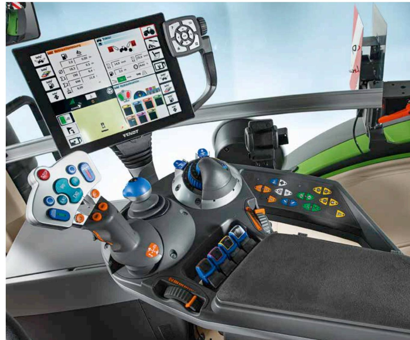
Элементы управления расположены на правом подлокотнике – Varioterminal 4-в-1, многофункциональный джойстик, крестообразный рычаг, модуль управления навесками EPS, управление гидрораспределителями и мембранная клавиатура создают хорошо сбалансированный общий дизайн и образуют эргономичный командный центр, где все находится под контролем.
