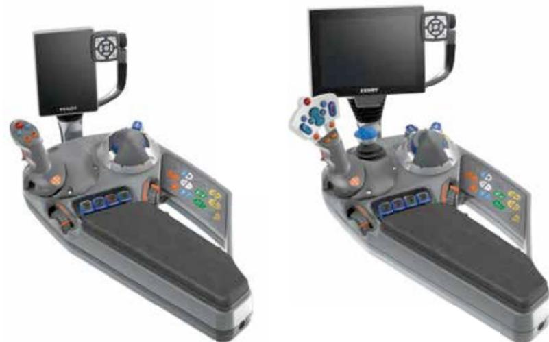
Мультифункциональный подлокотник в комплектации Power с Varioterminal 7-V; джойстик Power, кнопками круиз-контроля и предустановленных оборотов двигателя; органы управления навесками, MOM; Varioterminal 7-V с настоящей стеклянной поверхностью обладает интуитивной навигацией в меню, сенсорным и кнопочным управлением, а также системой управления рабочими орудиями, совместимыми с ISOBUS.
